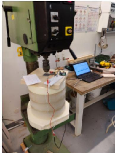
Prototype de la cuve chauffante
