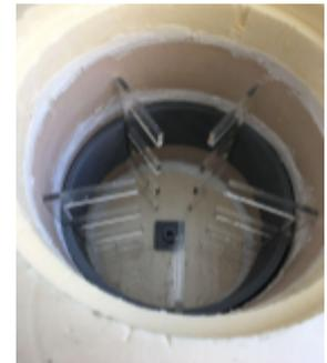
Figure 7: Intérieur de la cuve avec les pales fixes
